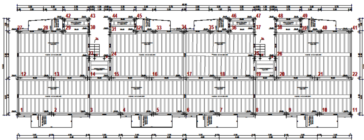
Figura 81: Strutture – pianta solaio piano terra
